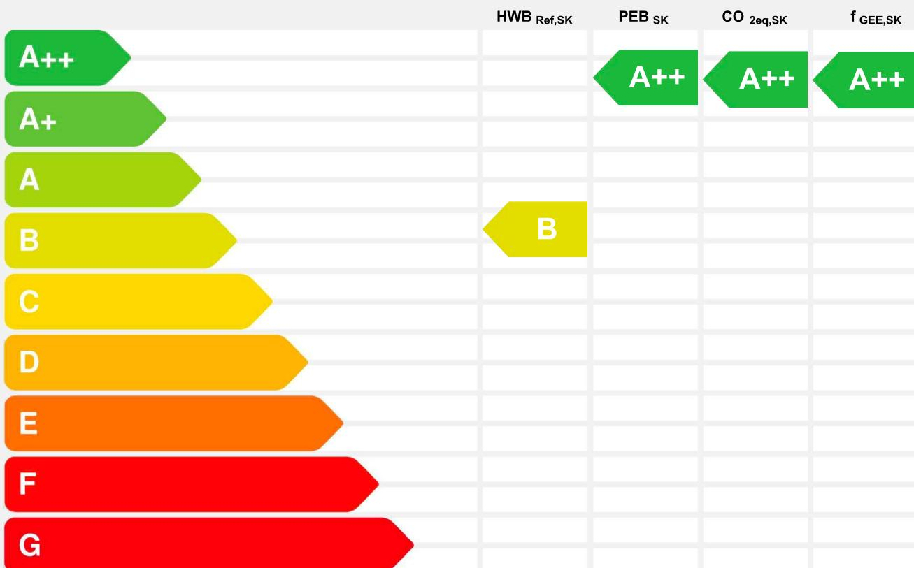
**HWB<sub>Ref</sub>**: Der **Referenz-Heizwärmeverbedarf** ist jene Wärmemenge, die in den Räumen bereitgestellt werden muss, um diese auf einer normativ geforderten Raumtemperatur, ohne Berücksichtigung allfälliger Erträge aus Wärmerückgewinnung, zu halten.
